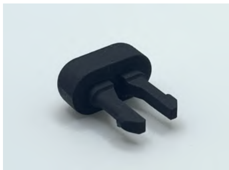
Lüfterversteller eines alten PKW, gedruckt mittels SLA-Verfahren
