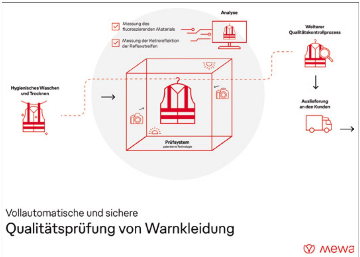
Mewa nutzt KI bei der Funktionsprüfung von Warnkleidung und erhöht damit die Ergebnissicherheit erheblich
