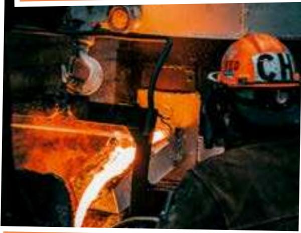
Du erzeugst Stahl. Du beschickst Hochöfen mit Einsatzstoffen wie Eisenerz, Koks sowie Eisenschrott und steuerst die Schmelzprozesse. Du überwachst die Temperaturen, regelst die Luft-
